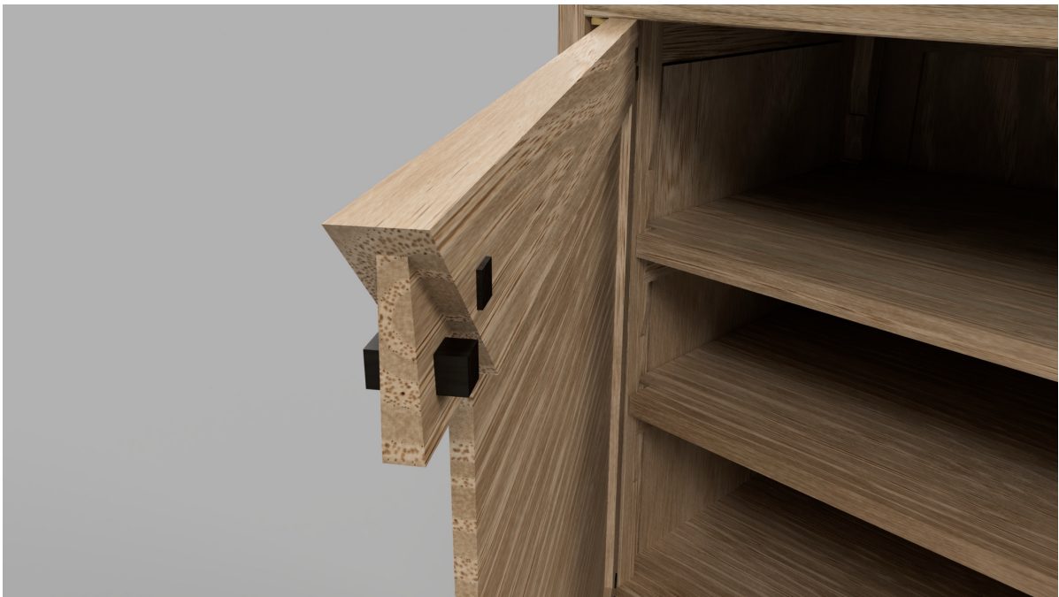
Abbildung 40: Eckverbindung: verdeckter schwalbenschwanzförmiger Zapfen auf Gehrung, zusätzlich durch Dübel fixiert (jap. 隠し留め蟻三枚ほぞ, Kakushi Tome Ari Sanmai Hozo)
