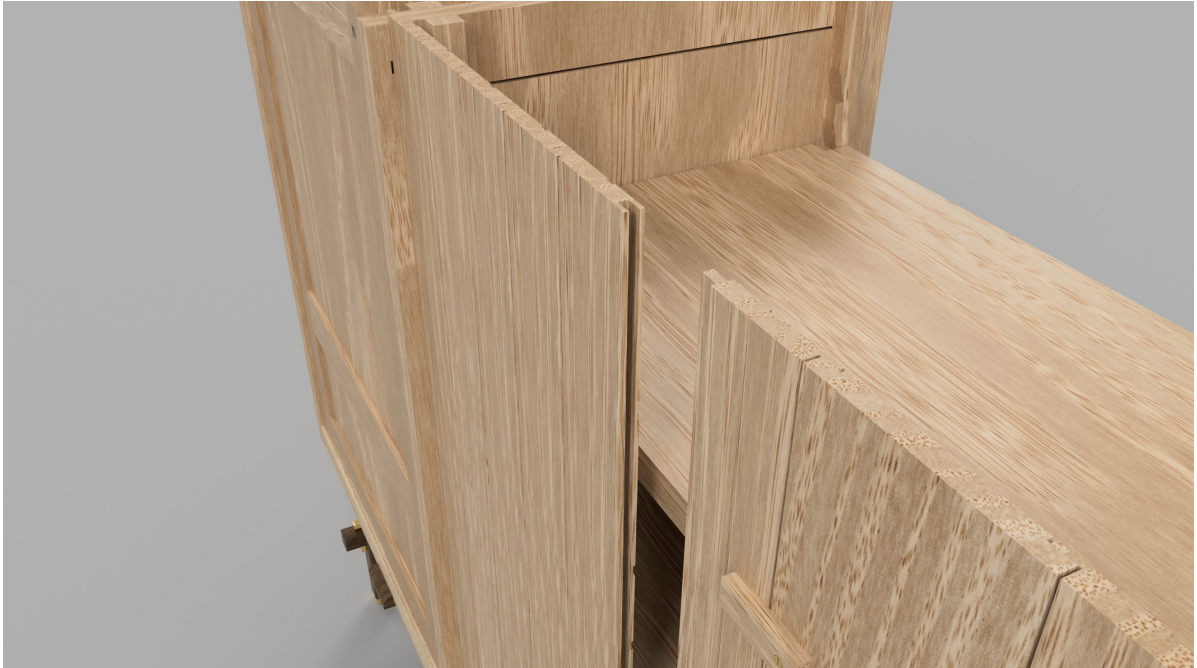
Abbildung 44: Detail Rückwand: Täfelung; Paneele mit Nut und Feder
