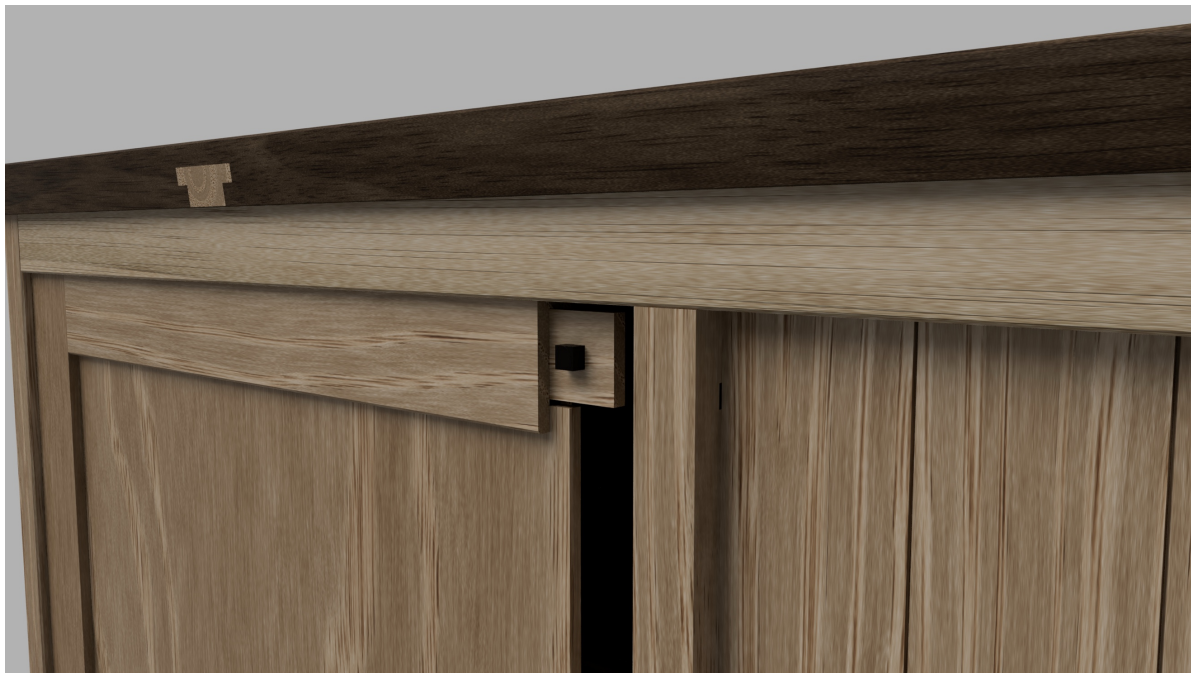
Abbildung 37: dübelgesicherter, gestemmter Zapfen im Rahmen der Rückwand
