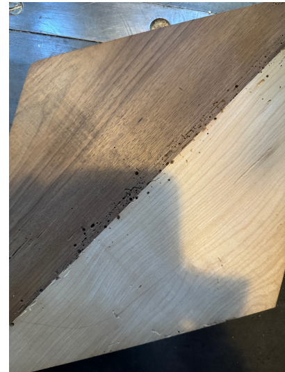
Abbildung 14: Spuren von Holzschädlingen entlang der Leimfuge
