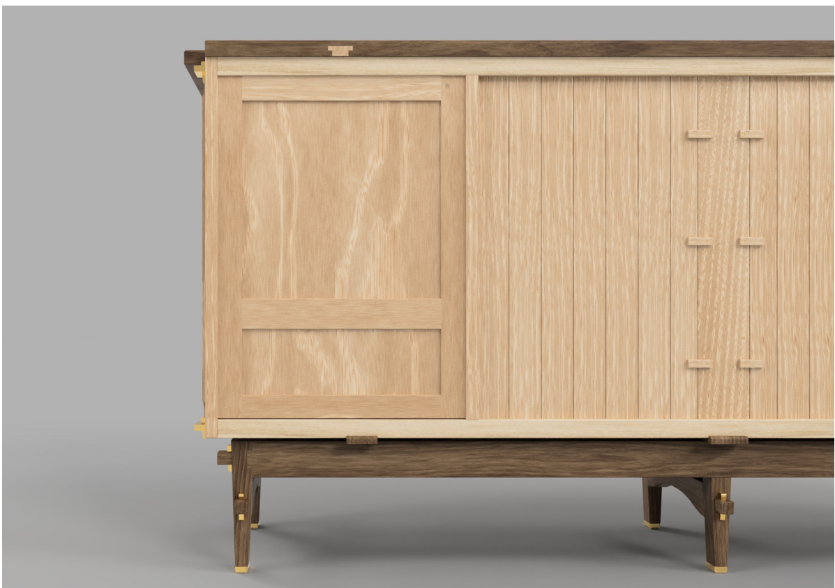
Abbildung 45: Rückwand: Rahmen-Füllungskonstruktion und Täfelung
