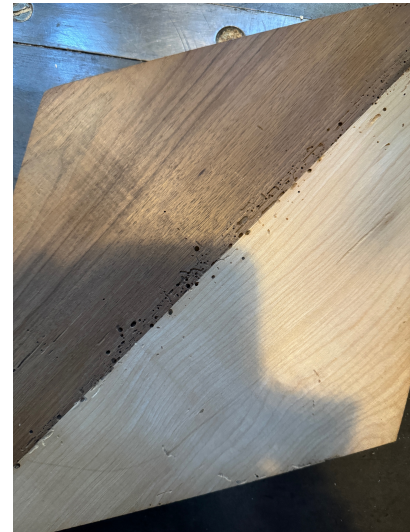
Abbildung 14: Spuren von Holzschädlingen entlang der Leimfuge
