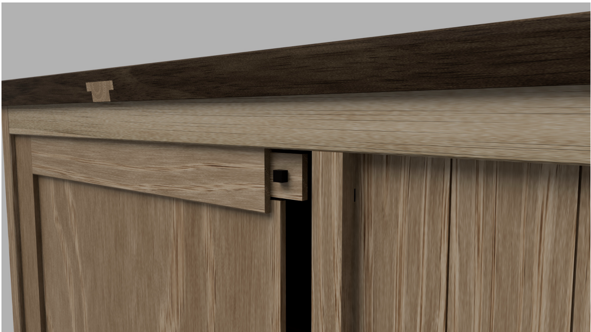
Abbildung 37: dübelgesicherter, gestemmter Zapfen im Rahmen der Rückwand
