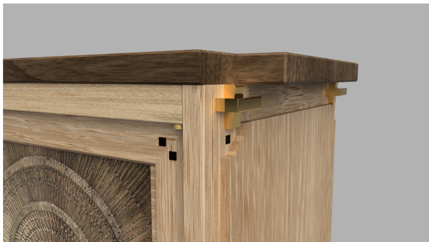
Abbildung 35: Messingzapfen und -keil
